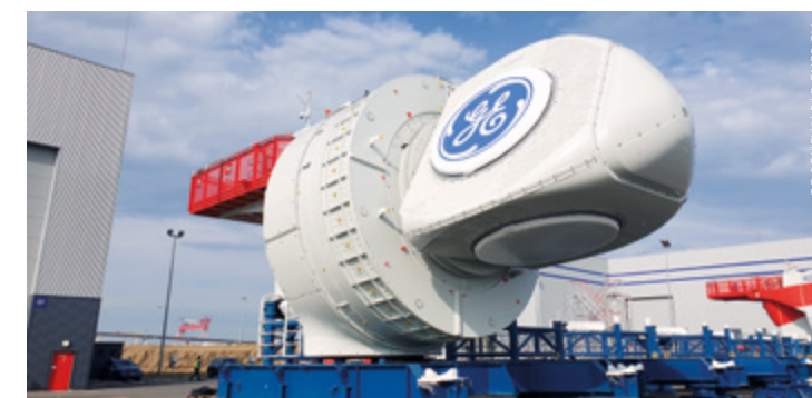
Première nacelle (contenant la génératrice) de la série d'éoliennes Haliade 150-6 MW de GE Renewable Energy. Elle est destinée au parc éolien en mer de Saint-Nazaire.
